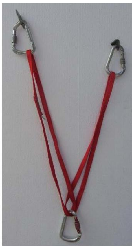
Клизно сидриште на две тачке
