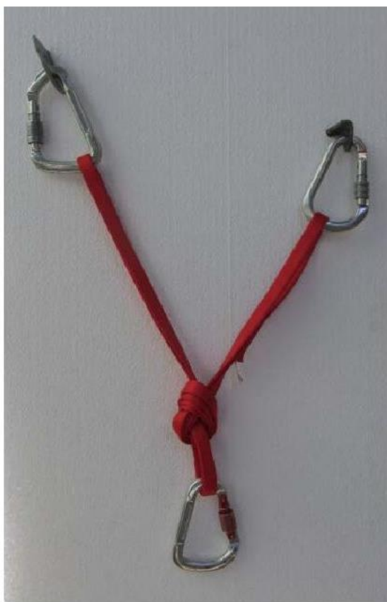
Фиксно сидриште на две тачке
