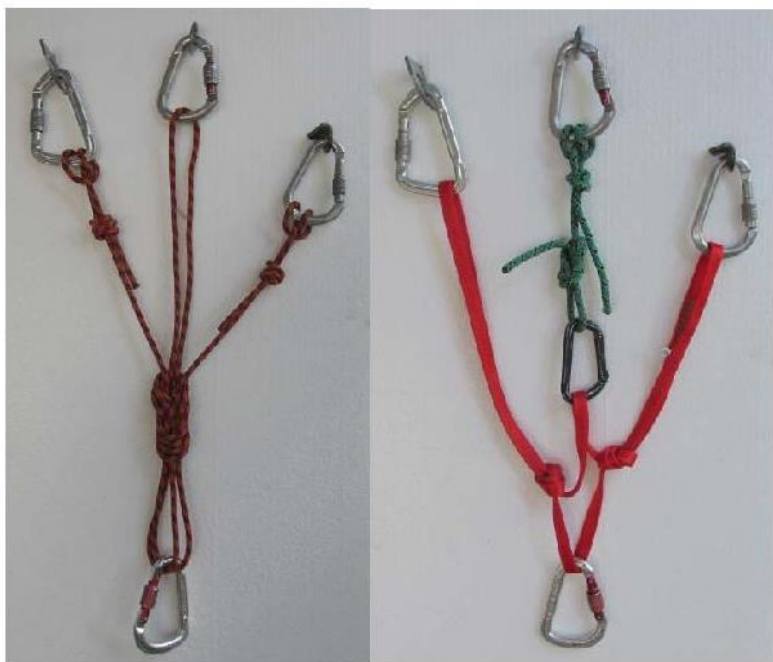
Фиксно подешавајуће сидриште на три тачке
